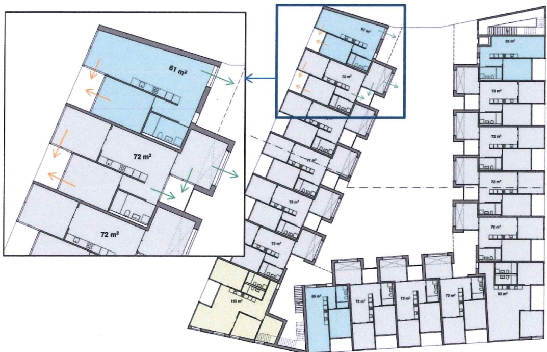
▲ Abb. 12 Grundriss 1. Obergeschoss mit Lüftungskonzept
