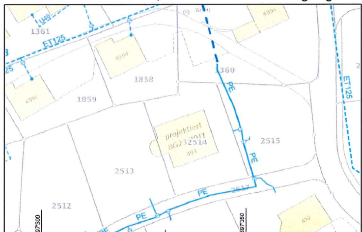
Abbildung rechts: Verlauf der Wasserversorgungsleitung
