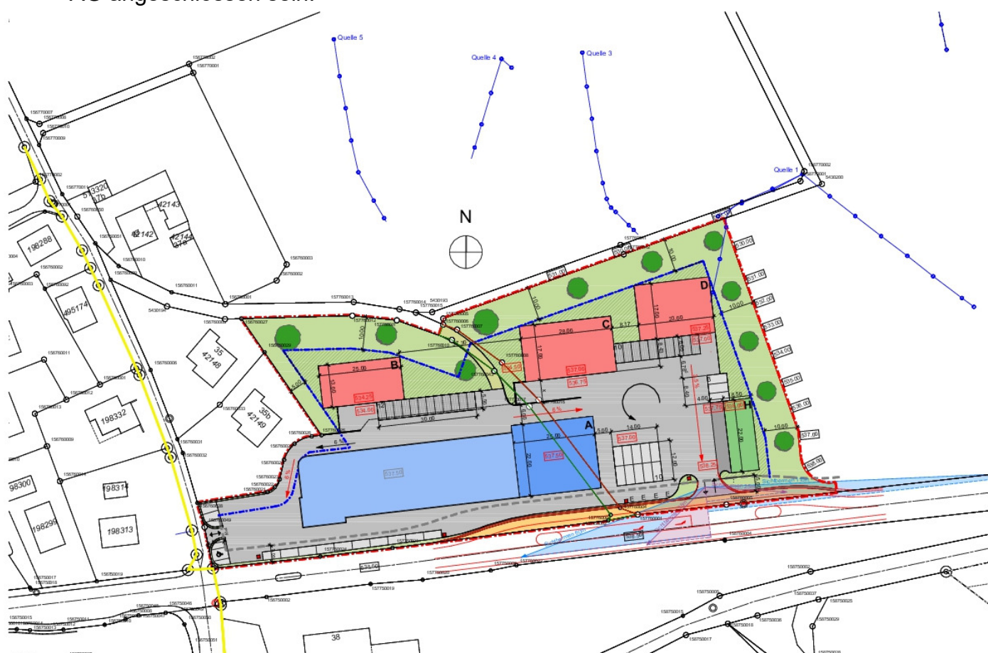
▲ Abb. 7 Erschliessung im Areal Müliacher Nord 1:1'500
